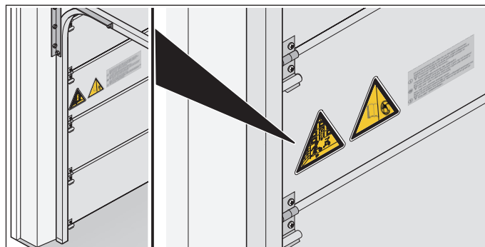
Abb. 1.2 Aufkleber am Torblatt anbringen
